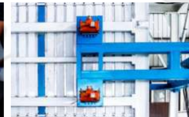
B 固定模具夹板 Fixing Mould Clamp
